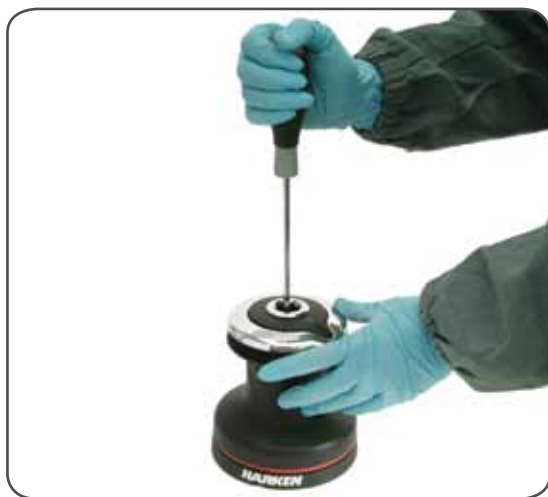
1. Odkręć śrubę główną (🔧 2Nm/18 in-lb)
