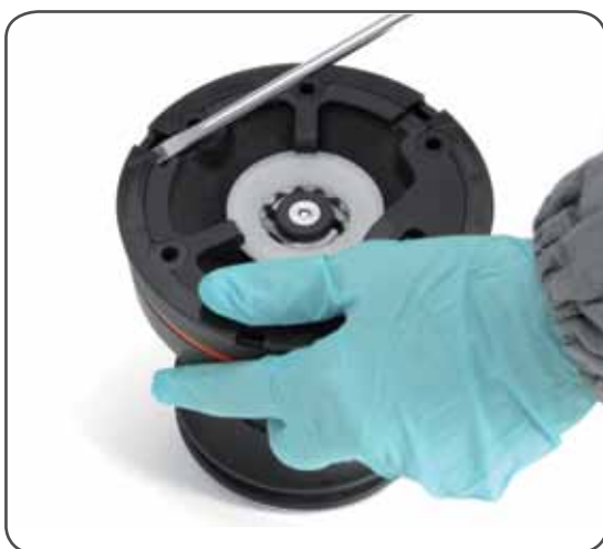
1. Za pomocą śrubokręta poluzuj kołnierz n°2
