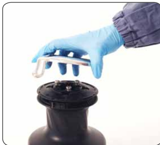
4. Obróć i zdejmij ramię układu samoknagowania n°18
