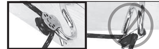
RYSUNEK 20. Ustaw oczka haków huśtawkowych w linii z kierunkiem prowadzenia liny wchodzącej do bločka.
